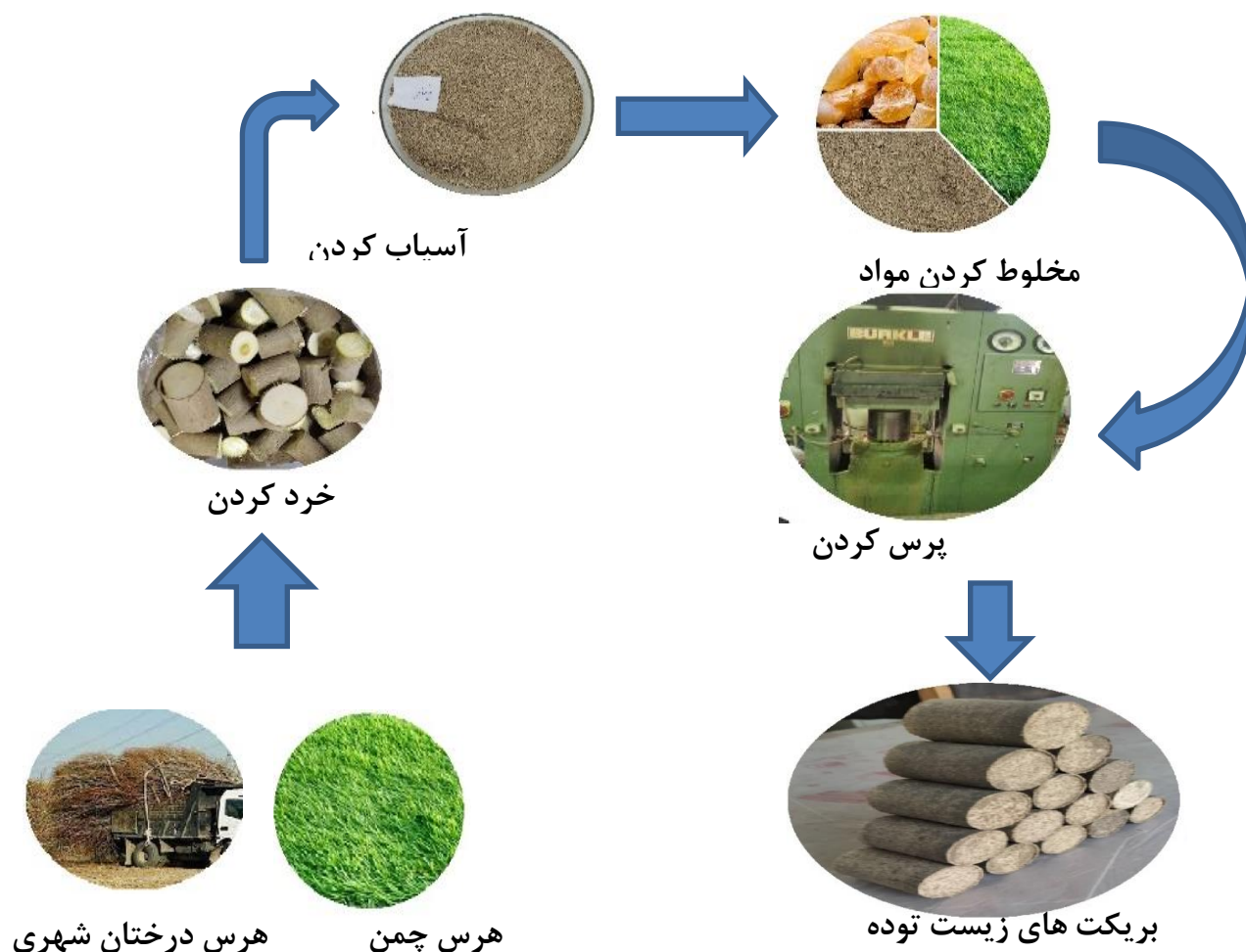
شکل ۱- فرآیند تولید سوخت زیستی از ضایعات چمن و هرس درختان در این مطالعه Figure 1- Biofuel production process from grass waste and tree pruning in this study
