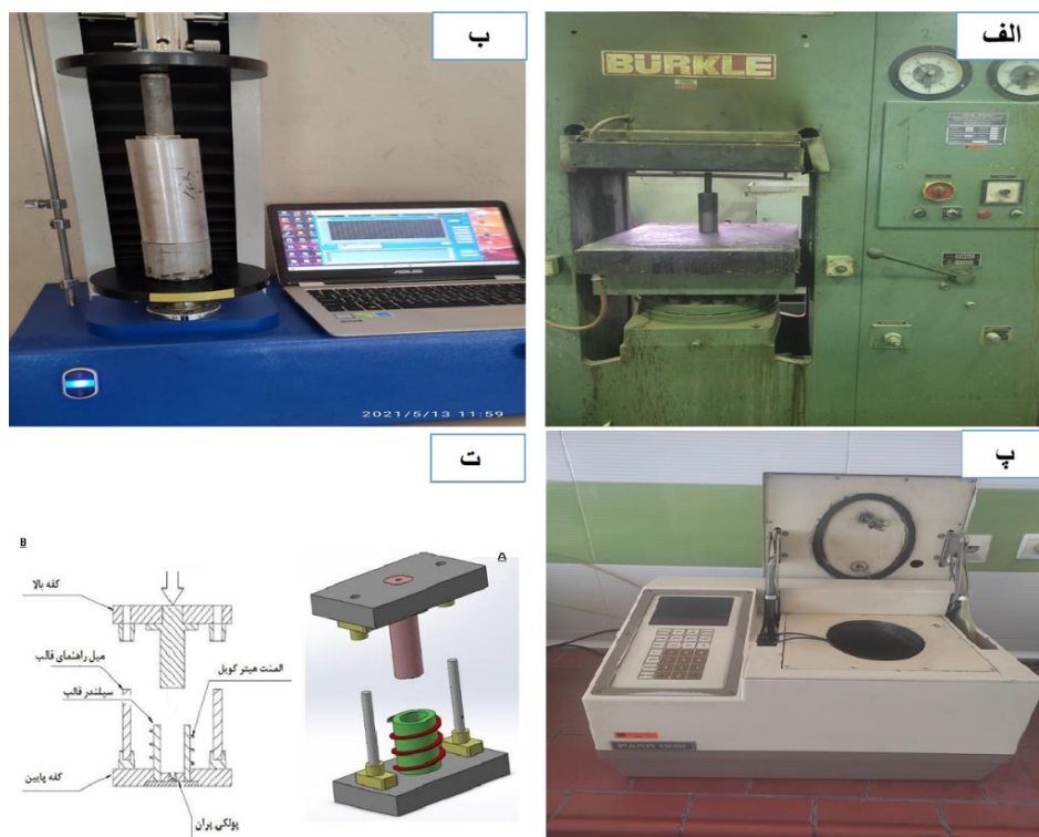
شکل ۲- نمایی از دستگاه‌های مورد استفاده شامل الف) دستگاه پرس، ب) دستگاه اینسترون، پ) دستگاه اندازه‌گیری تعیین ارزش حرارتی و ت) طرح قالب تولید نمونه‌های سوخت زیستی.
