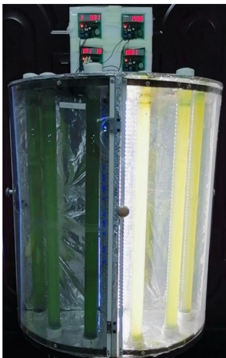
شکل ۱- فتوبیوراکتور عمودی مورد استفاده در آزمایش Figure 1- Vertical photobioreactor used in the experiment
