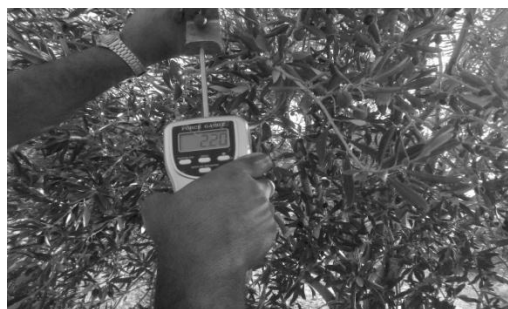
شکل ۹. به دست آوردن نیروی استاتیکی جداسازی میوه با استفاده از نیروسنج و قطعه ساخته شده
