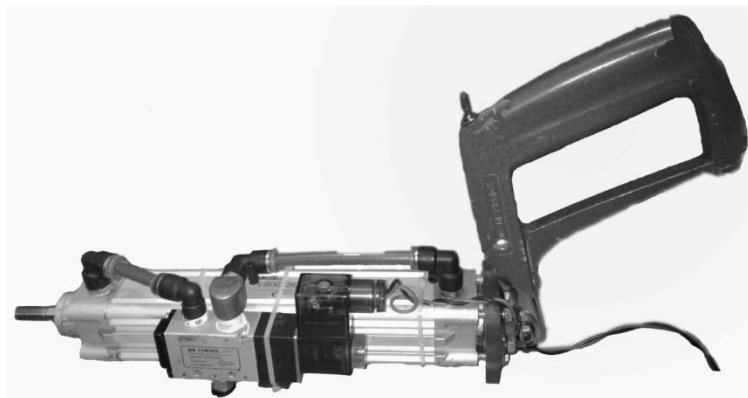
شکل ۳. مجموعه جک و شیر برقی کنترل جهت جریان ساخته شده
