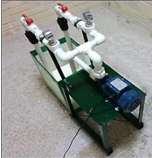
شکل ۶. سامانه شبیه‌ساز خوردگی
