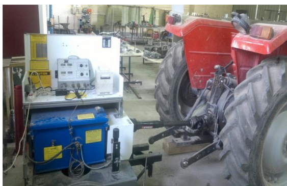
شکل ۱- تراکتور مسی فرگوسن و نحوه اتصال دینامومتر به آن
