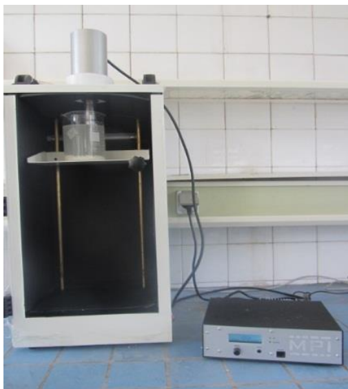
شکل ۱. تصویر مولد فراصوت همراه با مبدل در هنگام آزمون
