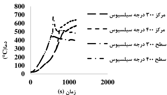
شکل ۲- نمودارهای تغییرات دما در سطح و مرکز نمونه‌های مکعب ۲/۵ سانتی‌متری
