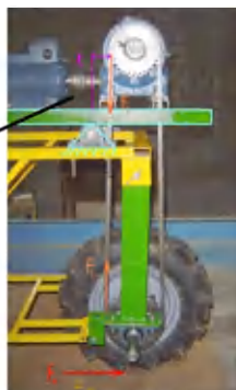
شکل ۳. الف- حسگرهای اندازه گیری نیروی کشش خالص؛ ب- موتور محرک و حسگر اندازه گیری نیروی کشش ناخالص
