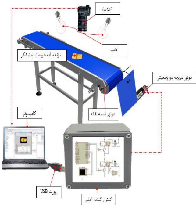
شکل ۴. شماتیک دستگاه جداسازی گره و میانگره
