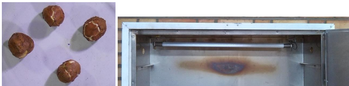
شکل ۱. محفظه و ساطع کننده امواج مادون قرمز و نمونه آزمایشی حرارت‌دهی شده.
