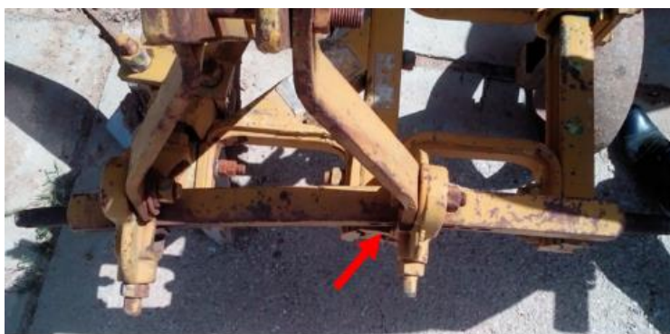
شکل ۱۴. تغییر شکل میله عرضی گاواهن برگردان‌دار در اثر خستگی
