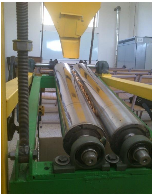
شکل ۸. واحد اندازه‌بند ساخته شده و نحوه قرارگیری مغزبادام در گذرگاه اندازه‌بندی
