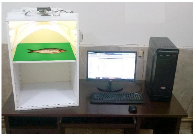
شکل ۱. طرحواره و تصویر سامانه بینایی ماشین
