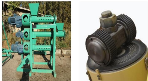
شکل ۱- دستگاه‌های فشرده ساز: الف- دای رولر ب- اکسترودر (Hara, 2001)
