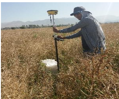
ه- تعیین موقعیت دقیق نمونه‌ها با کمک دستگاه RTKGPS
