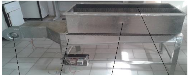
محفظه توری قابل تعویض مخزن خشک‌کن کاتال دوزنقه ای هوا دمنده شکل ۱. خشک‌کن آزمایشگاهی شلتوک
