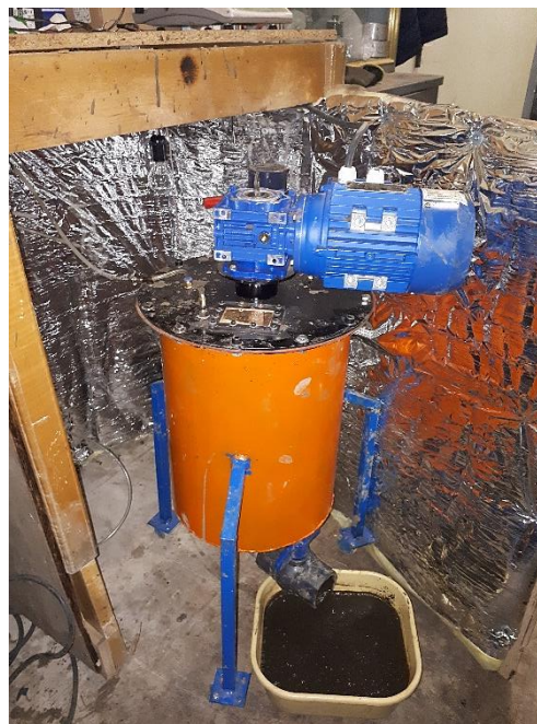
شکل ۲- راکتور اختلاط دائم (CSTR) برای انجام هضم بی‌هوازی پیوسته
