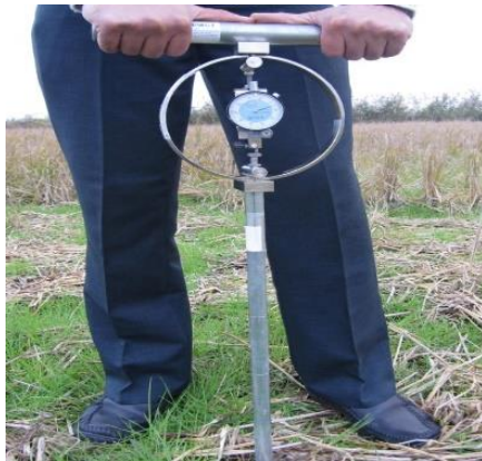
شکل ۱- آزمایش تعیین مقاومت به نفوذ خاک
