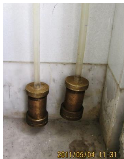
شکل ۳- آزمایش نفوذپذیری با روش بار افتان.
