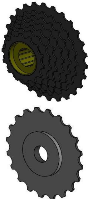
شکل ۹. الف. چرخ زنجیر طراحی شده در نرم‌افزار Solidworks ب. زنجیر سفت کن طراحی شده در نرم‌افزار Solidworks
