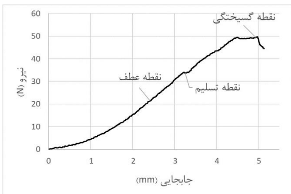
شکل ۴- نمودار نمونه نیرو-زمان در آزمون پانچ و فشار، نمایش نقاط گسیختگی، بیوبلد و نقطه عطف منحنی
