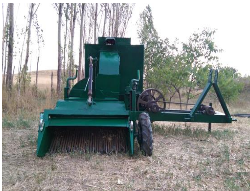
شکل ۲- دید کلی از دستگاه برداشت نخود و محفظه ته‌نشینی دستگاه؛ سمت راست: محفظه ته‌نشینی، سمت چپ: دستگاه برداشت نخود
