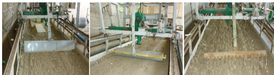
شکل ۳- مراحل فرآوری و آماده‌سازی خاک در انباره خاک
