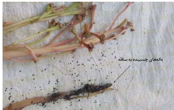
شکل ۴- دانه‌های خرفه چسبیده به ساقه در ماشین خرمن کوب خرفه در مقیاس آزمایشگاهی
