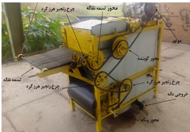
شکل ۳- نمای کلی و اجزاء دستگاه خرمن کوب خرفه ساخته شده
