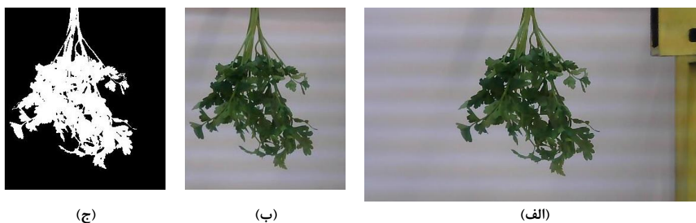
شکل ۵- فرآیند تشخیص قسمت برگی سبزی با پردازش تصویر به منظور تشخیص محل برش مناسب: (الف) ثبت تصویر اولیه، (ب) پیش‌پردازش (کالیبره کردن، برش و کاهش حجم) و (ج) استخراج محصول از پس‌زمینه با آستانه گذاری
