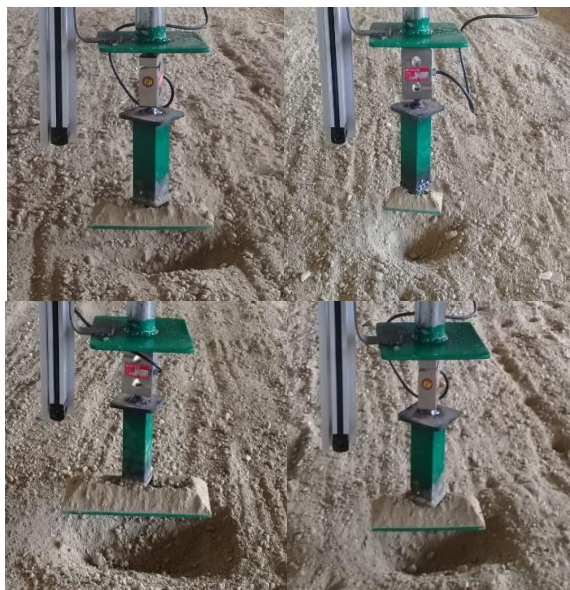
شکل ۴- چهار صفحه مستطیلی شکل مورد استفاده برای تعیین ثابت‌های خاک در مدل بکر.
