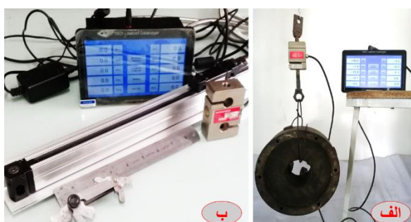
شکل ۳- (الف) - واسنجی نیروسنج‌ها با بارهایی در محدوده‌ی ابتدا، انتها و میانی ظرفیت اندازه‌گیری آن‌ها، (ب) - واسنجی و بررسی دقت سیستم سنجش جابجایی خطکش دیجیتالی.
