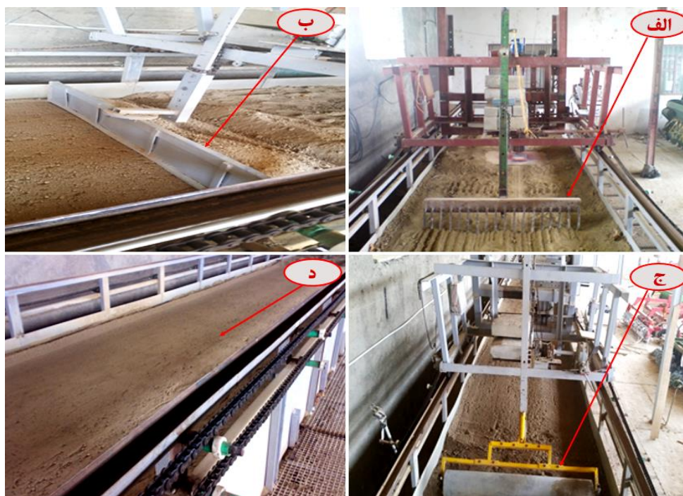
شکل ۲- مراحل آماده‌سازی خاک جهت انجام آزمایش‌ها: الف- نرم کردن خاک با چنگه، ب- عملیات تسطح با ماله، ج- غلتک زنی، د- بستر آماده‌شده.
