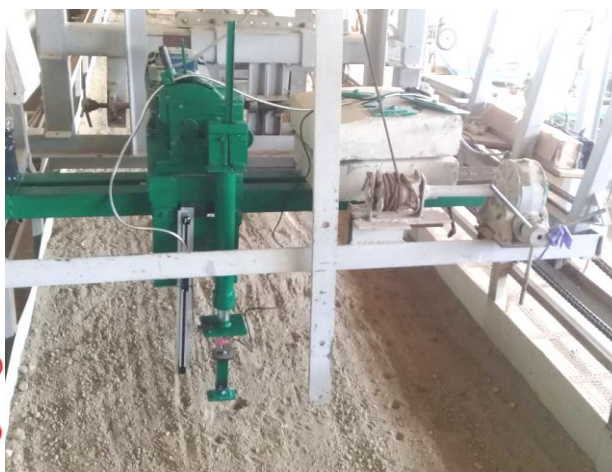
شکل ۱- نمایی از دستگاه نصب‌شده بر روی انباره خاک و نقشه انفجاری سامانه. ۱- شاسی، ۲- جعبه‌دنده، ۳- چرخ‌دنده شانه‌ای، ۴- پوسته و شفت جک برای هدایت چرخ‌دنده شانه‌ای، ۵- دسته متحرک جک، ۶- صفحه فشاری، ۷- نیروسنج ۸- خط‌کش دیجیتال ۹- الکتروموتور.
