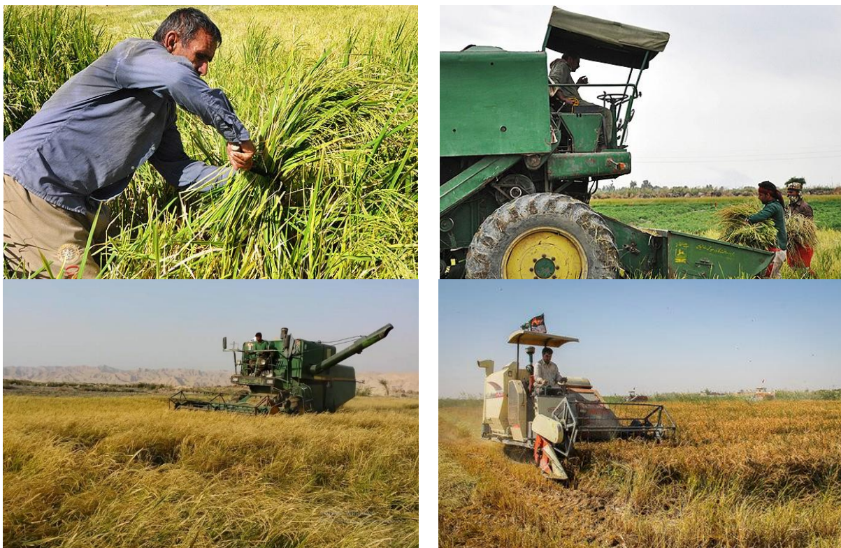
شکل ۳- سامانه‌های برداشت شلتوک (بالا: برداشت دو مرحله‌ای، پایین راست: برداشت مستقیم با کمباین برنج، پایین چپ: برداشت مستقیم با کمباین غلات) Figure 3. Harvesting systems of rice crop (Up right and left: two-stage, down and right: direct harvesting with rice combine harvester and down and left: direct harvesting with grain combine harvester)
