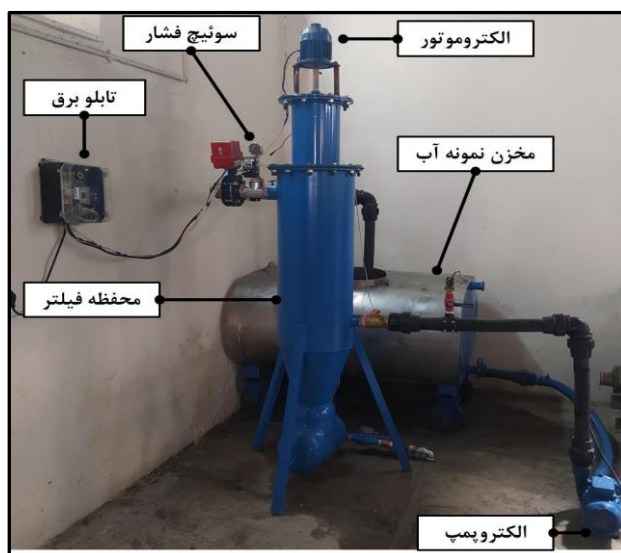
شکل ۳. سامانه فیلتراسیون ساخته شده برای ارزیابی عملکرد آن در خصوص تصفیه آب
